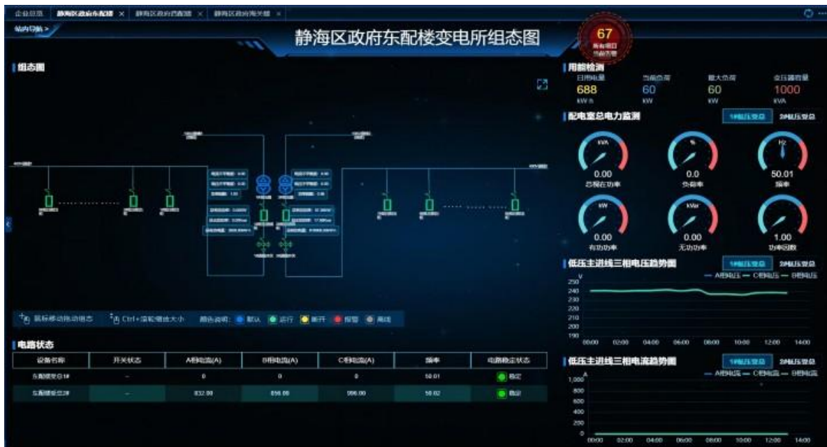
图 3 静海区政府东配楼变电所组态图
